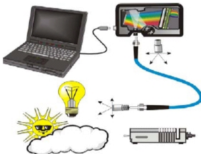
Obr.3: Schéma měření spektrálního složení světelných zdrojů
