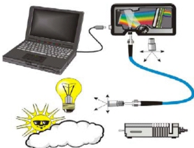
Obr.3: Schéma měření spektrálního složení světelných zdrojů
